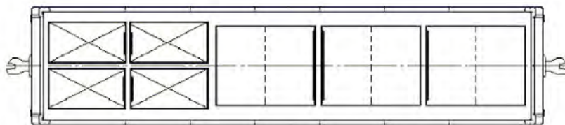
Рисунок 5 – Размещение контейнеров в контейнеровозе с торцевым ограждением в виде скоб или балок, закрепленных снаружи угловых стоек
